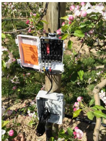
II-lustració 6. Instal·lació d'un punt de control a camp. Al centre, la instal·lació del comptador de reg. A la dreta, detall una sonda DECAGON 10HS.
