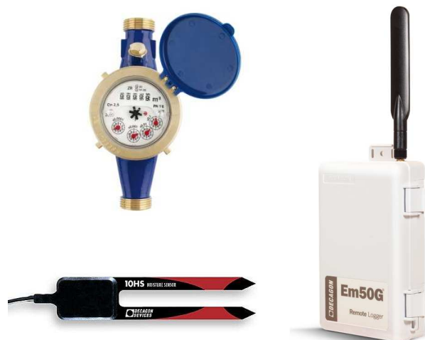
Il·lustració 15. A l'esquerra, punt de control d'humitat al sòl en pomeres. A la dreta, una mostra dels materials utilitzats: cabalímetre Zener, datalogger EM50G de DECAGON i sonda de lectura de la humitat del sòl de la casa DECAGON, model 10HS.
