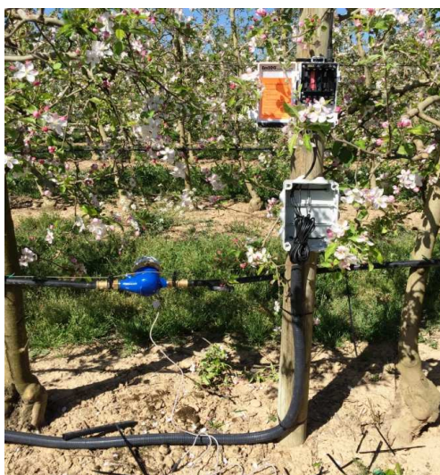
Il·lustració 15. A l'esquerra, punt de control d'humitat al sòl en pomeres. A la dreta, una mostra dels materials utilitzats: cabalímetre Zener, datalogger EM50G de DECAGON i sonda de lectura de la humitat del sòl de la casa DECAGON, model 10HS.
