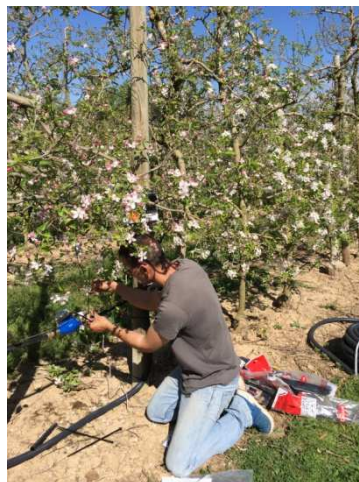
II-lustració 6. Instal·lació d'un punt de control a camp. Al centre, la instal·lació del comptador de reg. A la dreta, detall una sonda DECAGON 10HS.
